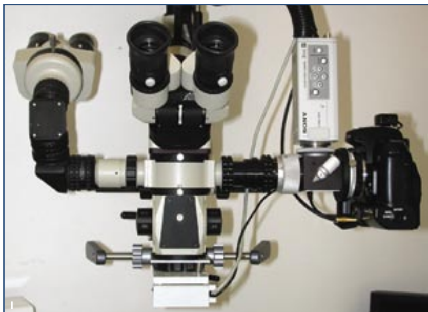
Figura 1 Il microscopio operatorio fornito di oculare per l'assistente, videocamera e macchina fotografica digitale.
